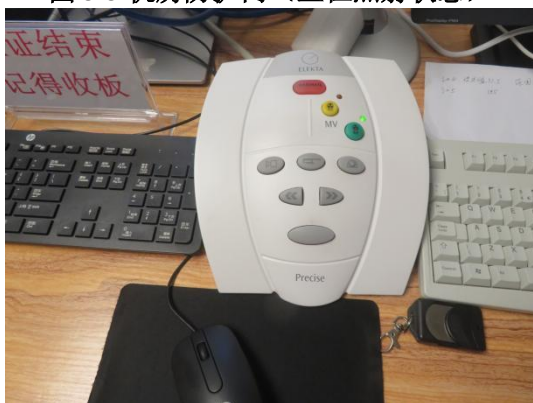
图 3-5 控制室内控制面板急停按钮
