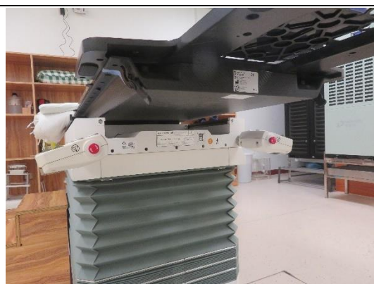
图 3-16 直线加速器机床急停按钮（一）
